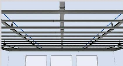
1 Corroborar que la estructura sustentante sea resistente a la compresión y esté a nivel.
