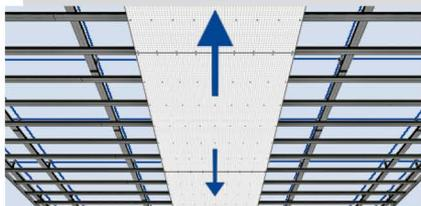
4 Colocar las placas en dirección de los longitudinales, después en dirección de los lados transversales, de modo que se logre un cruce exacto en el cielorraso. Las placas se colocan junta con junta (junta a tope).
